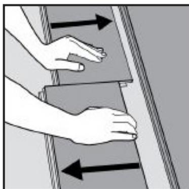
**2.** Trennen Sie die stirnseitige Verbindung, indem Sie die Elemente flach liegend, seitlich verschieben. Versuchen Sie nicht, die Elemente hochzuklappen, weil dadurch die Verbindung zerstört wird.
